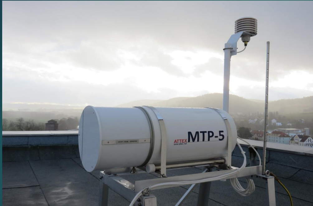
Метеорологический температурный профилемер МТП-5
